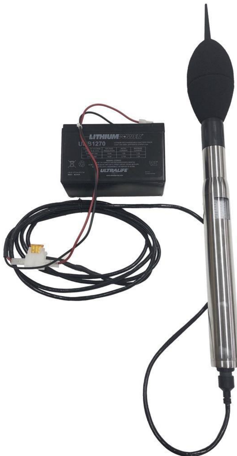
Abbildung 1: Schallpegelmesser AU-2000 mit Kabel AU-AQ-1786-010 und 12-Volt-Batterie
